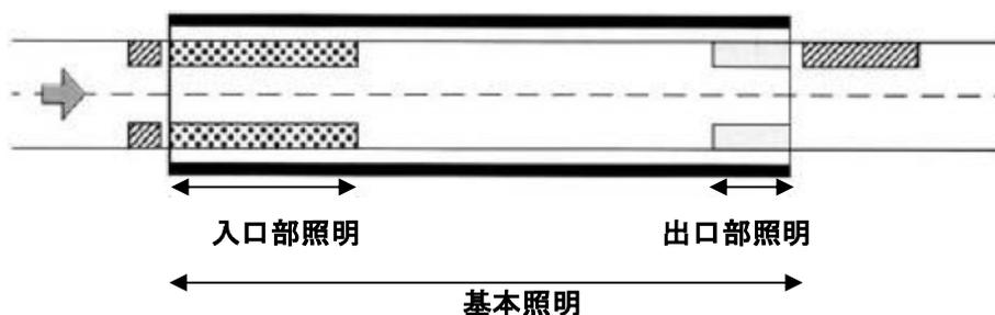
図 3.4.6.2-1 トンネル照明の構成
