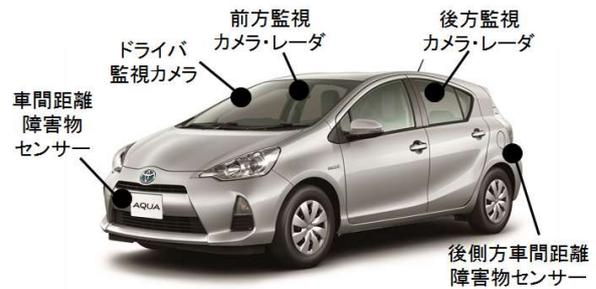
図 3.3.1.2 主な車載周囲環境認識センサ
