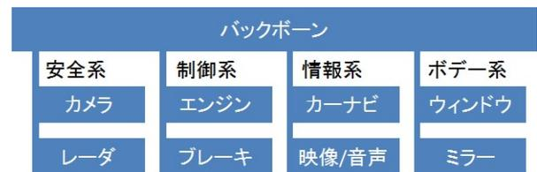
図 3.3.1-3 車載ネットワークシステムの概要
