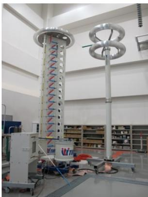
雷インパルス電圧試験機（1600kV、自然界の雷を模擬）
