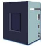
表面温度分布などを観測するサーモグラフィの校正に使用する平面黒体炉 (低反射材)
