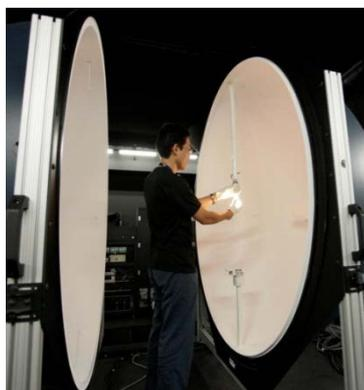
球形光束計（LED ランプなど各種光源の全光束測定）
