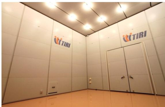
半無響室（機械装置の騒音を測定する音響試験室）
