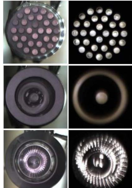
図 38 プロファイラにより測定された光源
